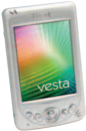
Внешне Vesta 400 – обычный КПК, но на задней панели у нее есть встроенная цифровая камера с VGA-разрешением и вспышка
