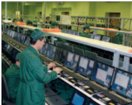
На прямо-сдаточных испытаниях проверяются абсолютно все компоненты системы
