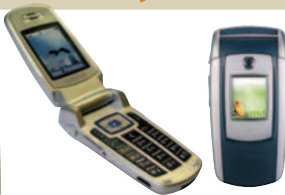
Внутренний TFT-дисплей имеет разрешение 128x160 точек и способен отображать до 65 тыс. цветов. В режиме написания сообщений на нем помещается до 5 строк текста по 16 символов в каждой, плюс три служебные строки. К сожалению, при ярком солнце рассмотреть содержимое дисплея достаточно тяжело.
