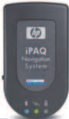
iPAQ Navigation System, посредством беспроводной связи Bluetooth превращающий iPAQ Pocket PC в автомобильную навигационную систему
