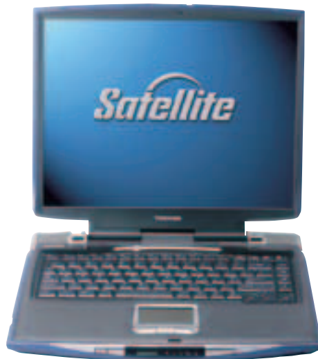
▲ Toshiba Satellite 5205-S705 оснащена 15-дюймовым UXGA-дисплеем и сабвуфером
