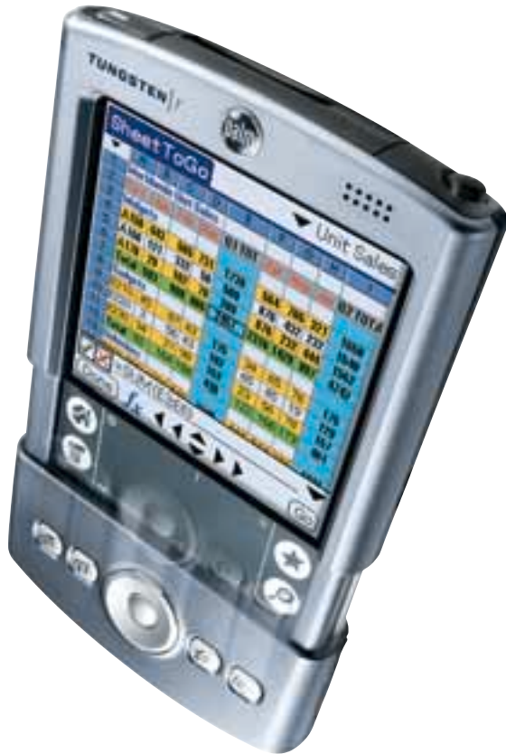
▲ Область Graffiti в модели Palm Tungsten T «прчется» под сдвигаемой кнопочной панелью
