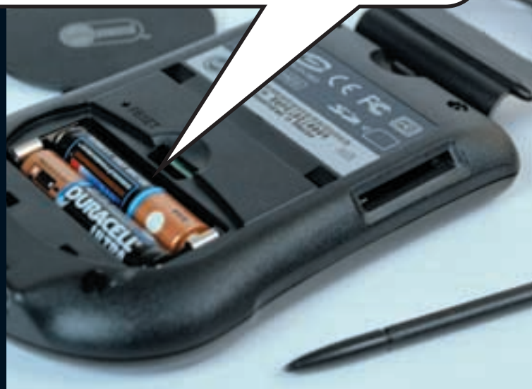
Слот расширения SD/MMC находится сбоку
