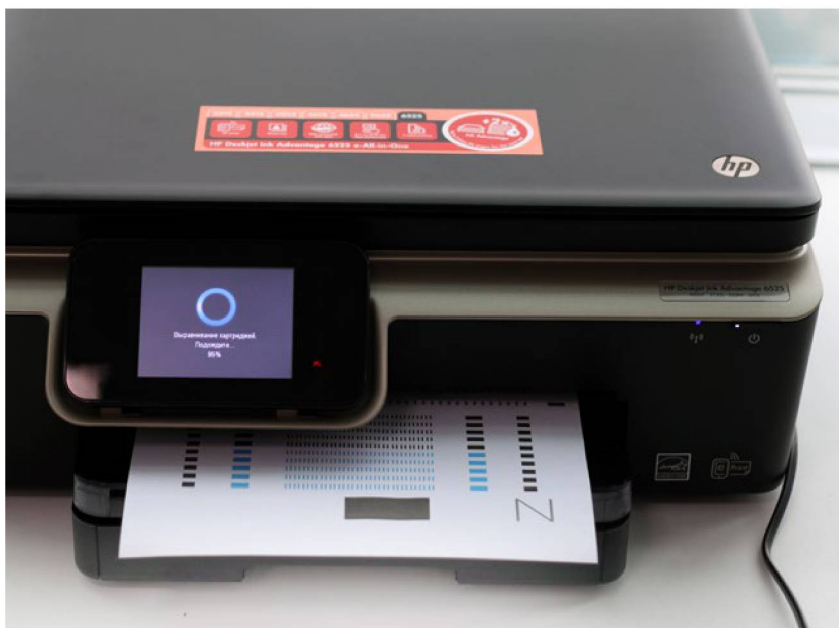
HP Deskjet Ink Advantage 6525 e-All-in-One. Вид спереди. Поскольку планшетный сканер не имеет автоподатчика документов, МФУ получилось невысоким
