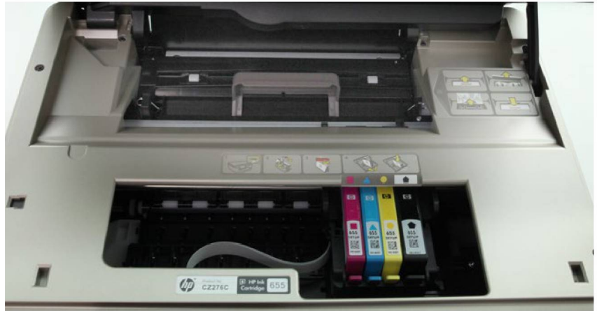
Каретка с отдельными чернильными картриджами. Выше – легкоъемная крышка для устранения замятий бумаги
