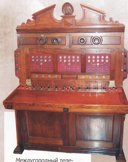
Междугородный телефонный коммутатор ручного обслуживания на 30 номеров. «Л. М. Эрикссон и Ко.», Санкт-Петербург, 1898 г.
