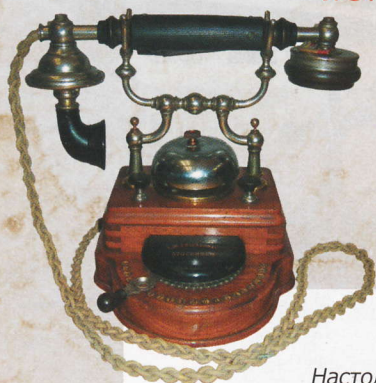
Настольный телефон системы МБ с коммутатором на 20 номеров. Швеция, 1910 г.
