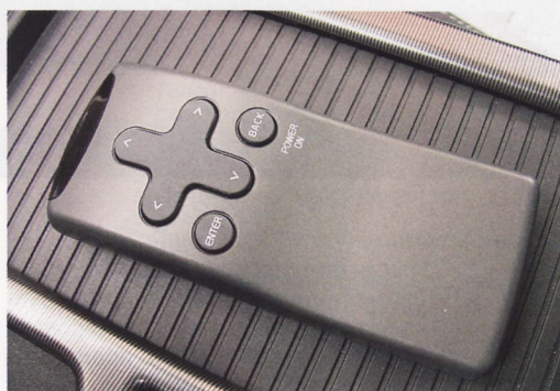
Пульт управления навигацией для пассажиров
