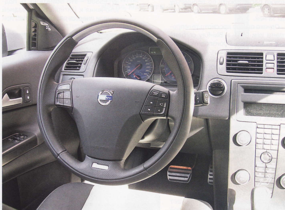
Кнопки на руле и индикатор системы BLIS
