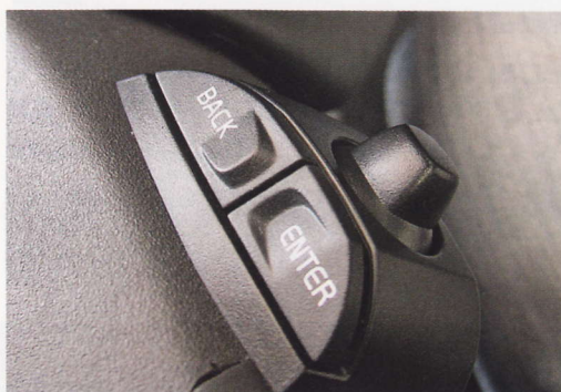
Блок управления навигацией с обратной стороны руля
