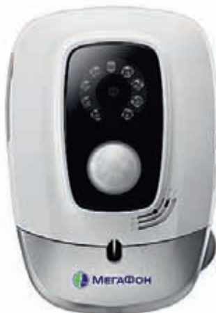
Мобильная MMS-камера (посылает MMS с фотографиями при срабатывании тревожного датчика)
