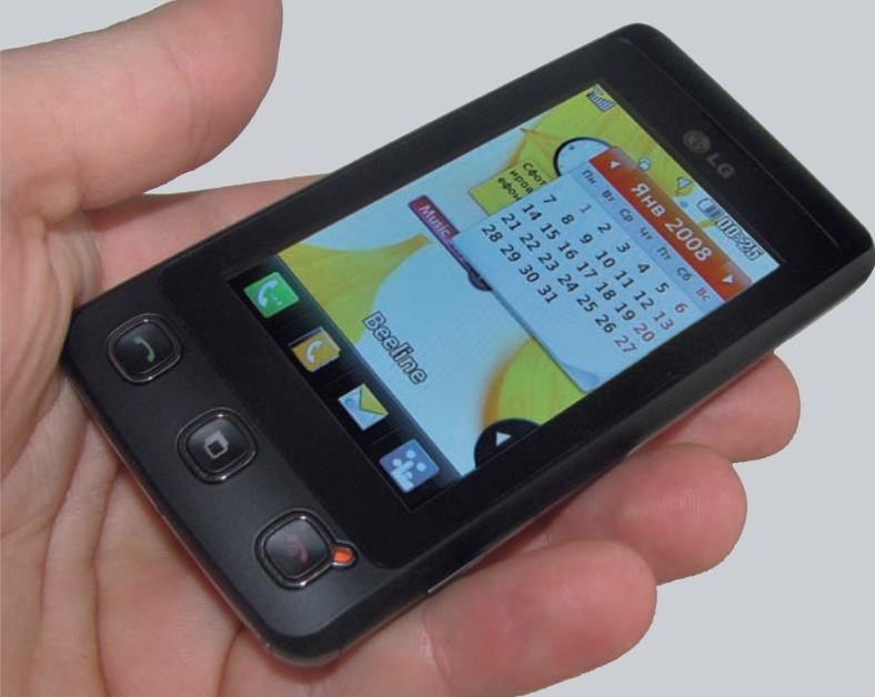
После испытания с металлическим шариком на дисплее не осталось даже царапин
