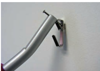
Устройство, которое может обезопасить вас от меткого попадания молотком по собственным пальцам: за счет наличия магнитов вероятность такого «попадания» резко уменьшается
