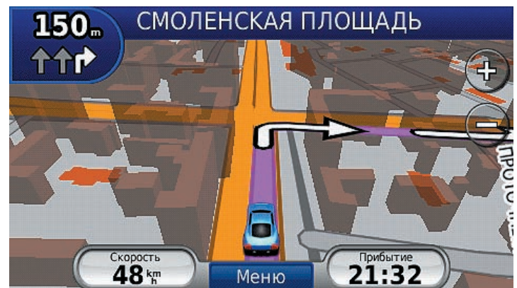
Перед подъездом к сложному перекрестку в левом верхнем углу экрана высвечивается подсказка, с какой полосы можно выполнить следующий маневр
