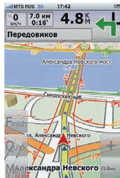
По количеству цветных линий со значениями скорости видно, как много автомобилей едет с включенным City Guide, ведь каждая линия — это фактически след от, как минимум, одного автомобиля за последний десяток минут
