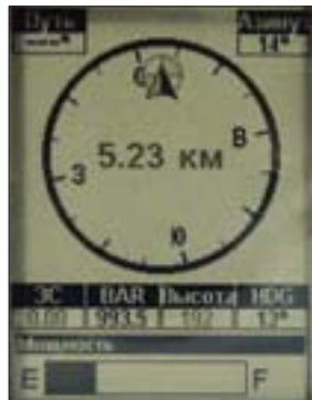
Страница с компасом со сторонами света, указателем курса и символом путевой точки
